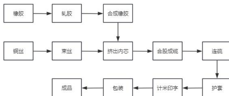
图1.2-1 橡套电缆生产工艺流程图
